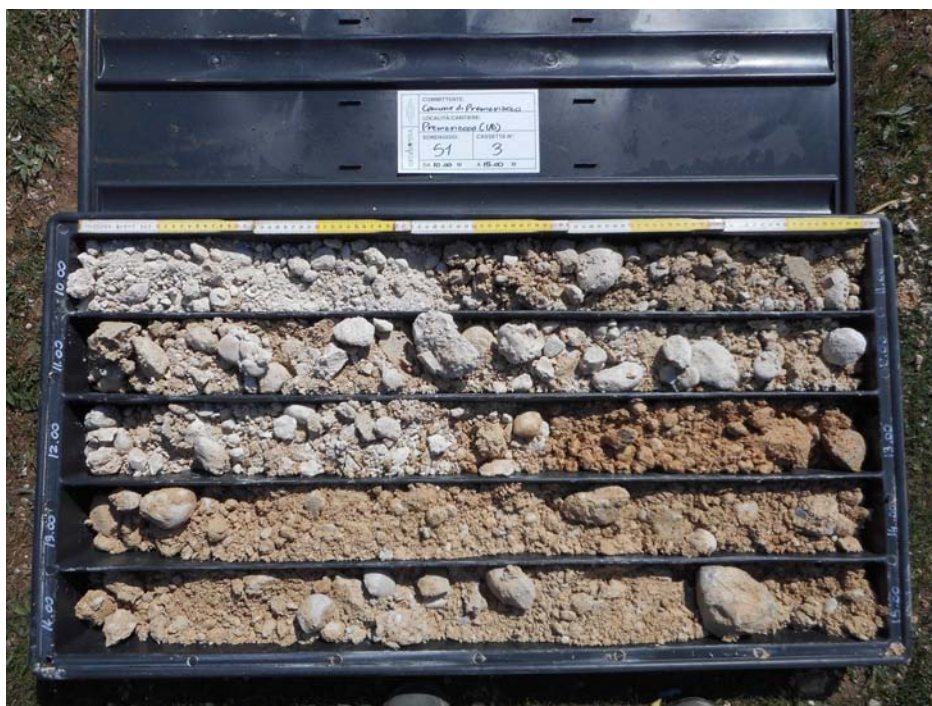
Sondaggio S1: cassetta n° 3, da 10.00 m a 15.00 m.
