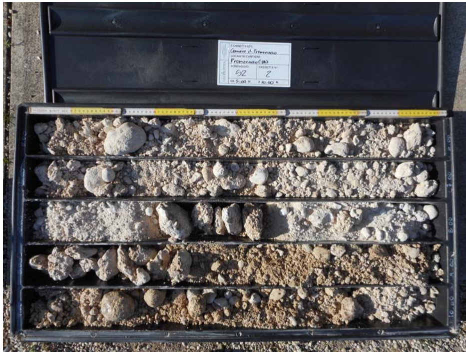
Sondaggio S2: cassetta n° 2, da 5.00 m a 10.00 m.
