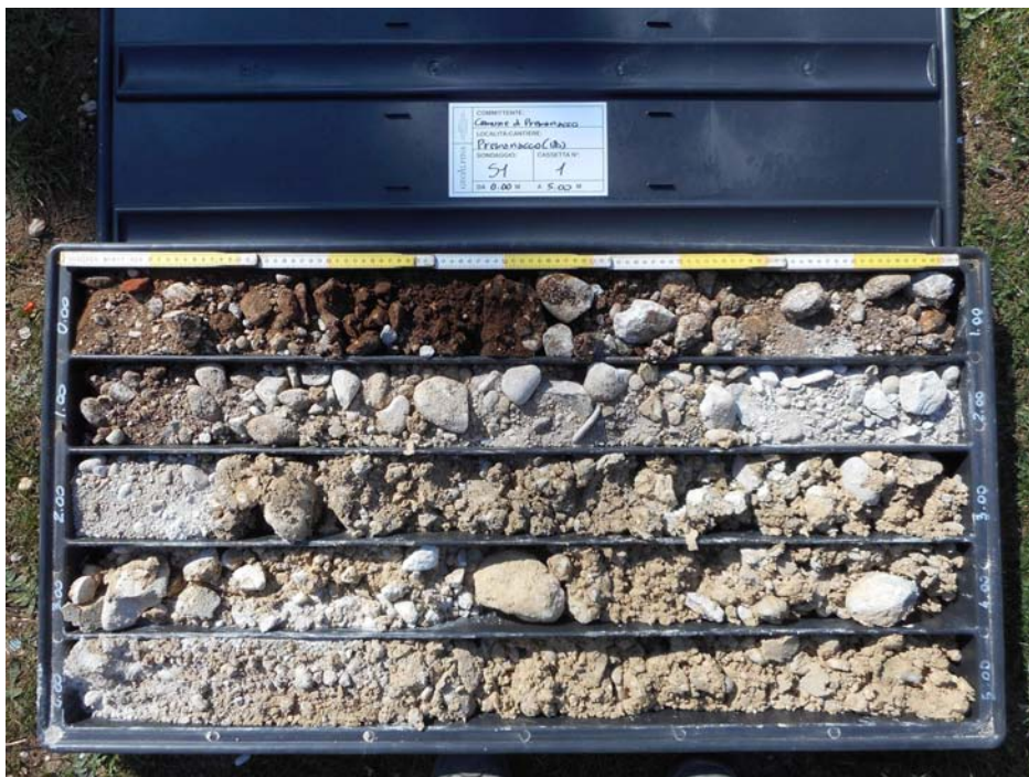
Sondaggio S1: cassetta n° 1, da 0.00 m a 5.00 m.
