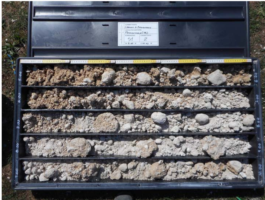
Sondaggio S1: cassetta n° 2, da 5.00 m a 10.00 m.
