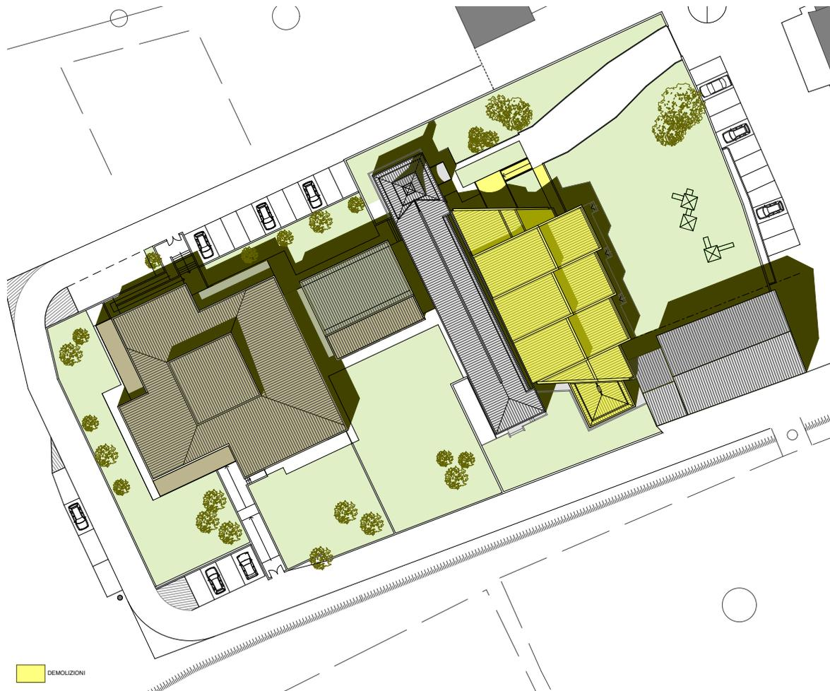
Fig. 2 Individuato in giallo l'edificio da demolire
